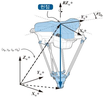
프레임 마운트 바닥면의 중심을 원점으로 하여, Tool center point의 위치와 방향을 나타내는 직교 좌표계입니다.
