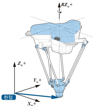
매니플레이터를 설치한 공간의 임의의 점을 원점으로 하여, Tool center point의 위치와 방향을 나타내는 직교 좌표계입니다.
